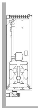
En fonction de la température de l'eau et ambiante mesurée, l'appareil fonctionnera par modulation entre 26 dB(A) (= vitesse 1) et 30 dB(A) (= vitesse 2). On obtient la puissance maximale avec le boost manuel (= vitesse 3).
